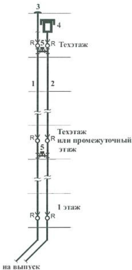
1 - основной водосточный стояк; 2 - резервный водосточный стояк; 3 - водосточная воронка; 4 - автоматический воздушный клапан; 5 - перемычка; R - ревизия
