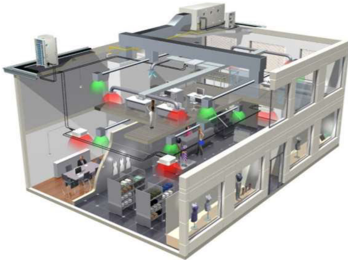
Рис. 4. Инженерные системы. Системы общеобменной вентиляции
