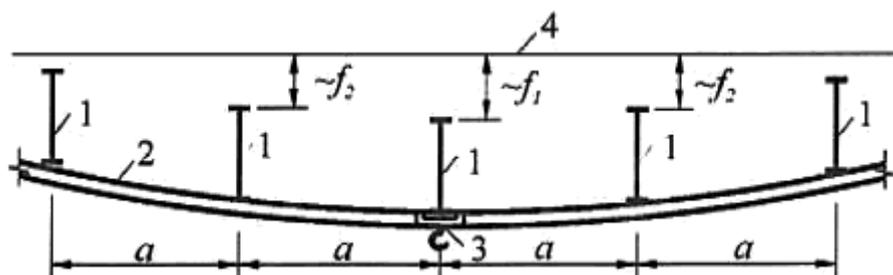
1 - стропильные конструкции; 2 - балка подвесного кранового пути; 3 - подвесной кран; 4 - исходное положение стропильных конструкций;  $f_1$  - прогиб наиболее нагруженной стропильной конструкции;  $f_2$  - прогибы смежных с наиболее нагруженной стропильных конструкций
