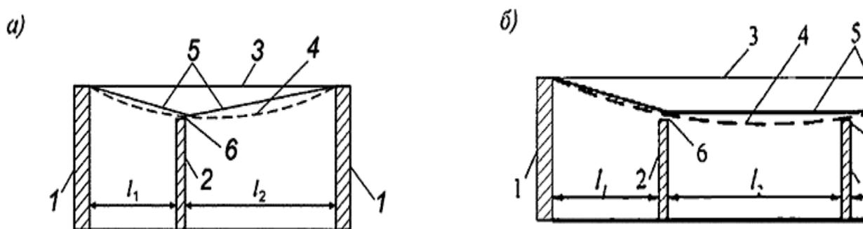
а) - одной в пролете; б) - двух в пролете; 1 - несущие стены (или колонны); 2 - капитальные перегородки; 3 - перекрытие (покрытие) до приложения нагрузки; 4 - перекрытие (покрытие) после приложения нагрузки; 5 - линии отсчета прогибов; 6 - зазор
