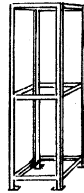
Рис. 58. Сварной каркас из угловой стали
